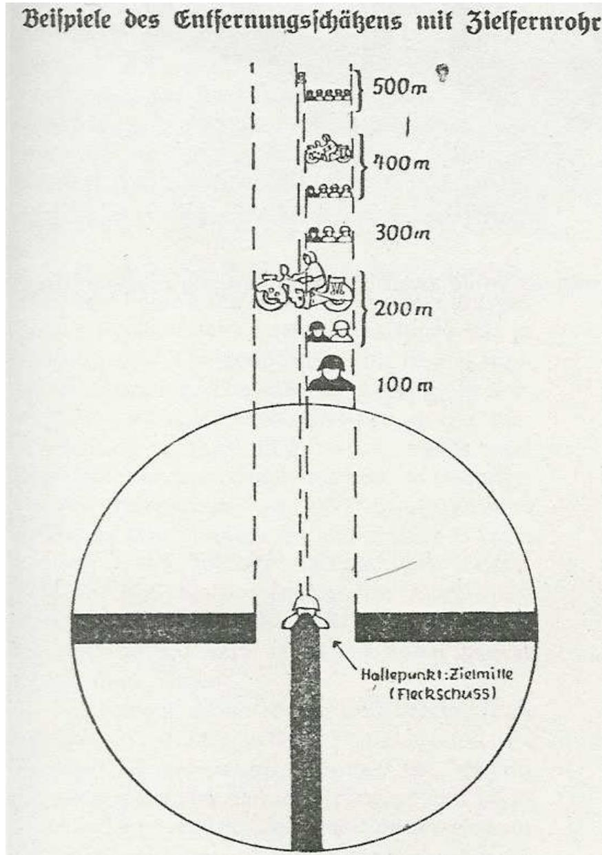
L'illustration ci-dessus est tirée d'un manuel de 1943 qui explique comment déterminer une distance de tir avec la lunette avec réticule standard type 1.
